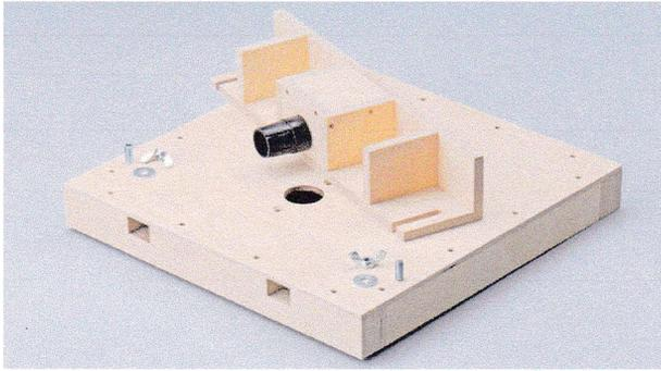
Frästisch mit fertigem Anschlag.
